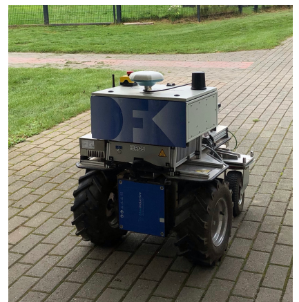
Abbildung 1: Roboter mit eingebauten Sensoren und Laser (kleinste Version)
